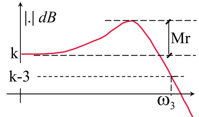
**Attenzione** :  $B_3 = \omega_3 / 2\pi$  in Hz
