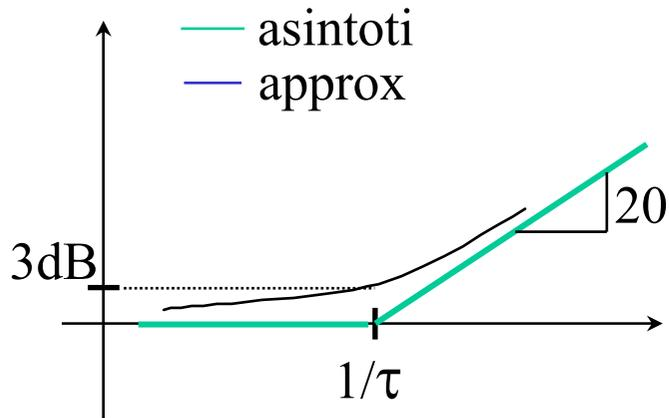
$$|1/G(j\omega)|_{\text{dB}} = -|G(j\omega)|_{\text{dB}}$$
