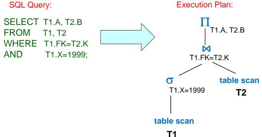
l'esecuzione della query potrà essere basata sull'allocazione di un thread/processo per operatore, collegati tramite una pipeline tee-and-join
